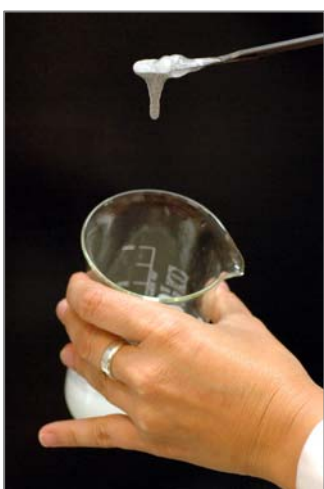
Figura 10.- El gel debe quedar con una consistencia de pasta fluida para facilitar su extensión sobre la superficie pintada
