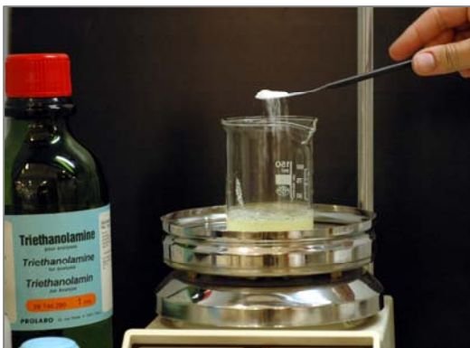
Figura 9.- Finalmente se añade el espesante, lentamente y manteniendo la agitación, evitando en lo posible la formación de grumos
