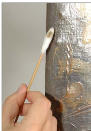
Figura1.- Separación de una muestra de barniz con hisopo (izquierda) y con un raspado superficial (derecha)
