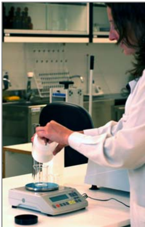
Figura 7.- Antes de iniciar la elaboración del gel es necesario haber calculado, pesado y medido correctamente todos los componentes del gel
