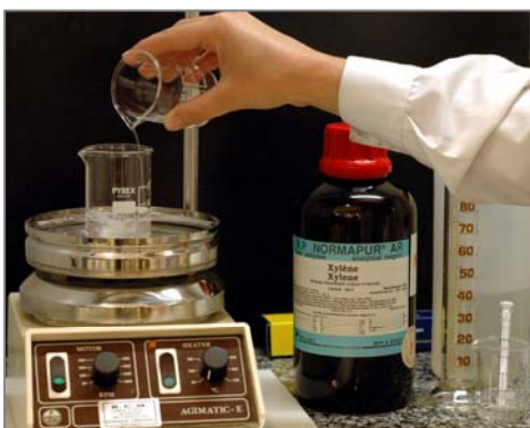
Figura 8.- Las mezclas se realizarán preferentemente en un agitador magnético, añadiendo uno a uno los disolventes y manteniendo una agitación constante
